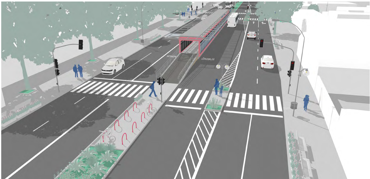
Perspectiva do canteiro central que dá acesso à estação de transporte coletivo, com travessias sinalizadas e semaforizadas, ilha de refúgio e paraciclos,
