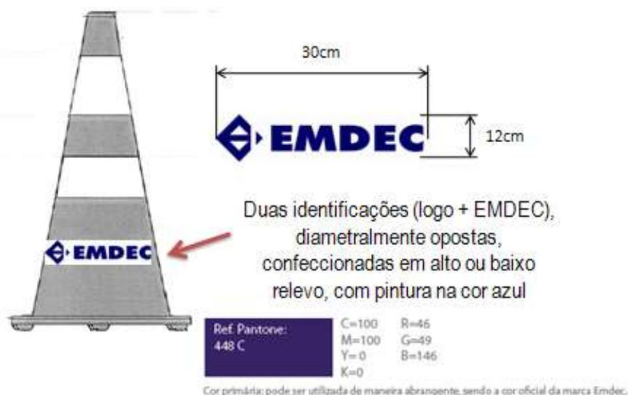
2.1.9 Além desta marcação, o cone deve conter, em relevo, gravado no corpo, de forma legível, a identificação do fabricante ou fornecedor, o mês e/ou ano de fabricação.
