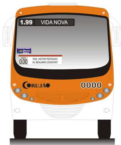
Bilhete Único: os veículos que operam no sistema INTERCAMP deverão fornecer o aviso de integração de bilhetagem, no vidro dianteiro direito, acima da placa de Indicação Complementar Dianteira, com medidas de 300mm por 150mm, conforme desenho.
