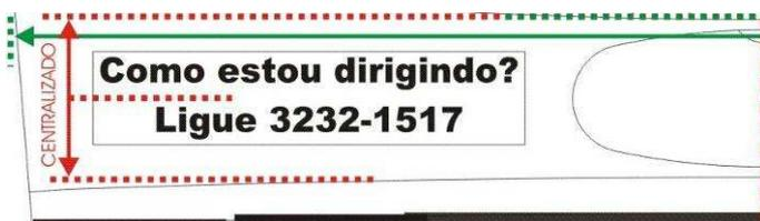
Deverá ser aplicado no pára-choque traseiro, lado esquerdo a 300mm da lateral do veículo. Caso ocorra alguma interferência física (borrachão, sulcos, batente, etc.), será
