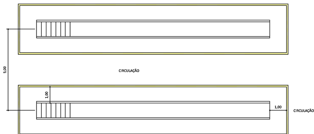
Figura 2 - Distanciamento Mínimo Entre Valetas
